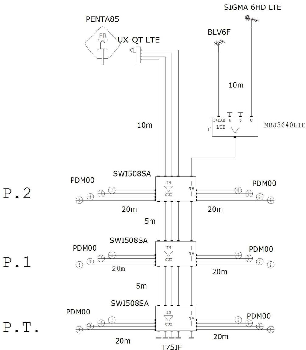
L'indicazione delle antenne, dei supporti porta-antenna e dei preamplificatori da palo nello schema è puramente indicativa, in quanto la scelta dipende esclusivamente dalla tipologia di segnale TV ricevuto nella zona di realizzazione dell'impianto e dalla struttura dello stabile
